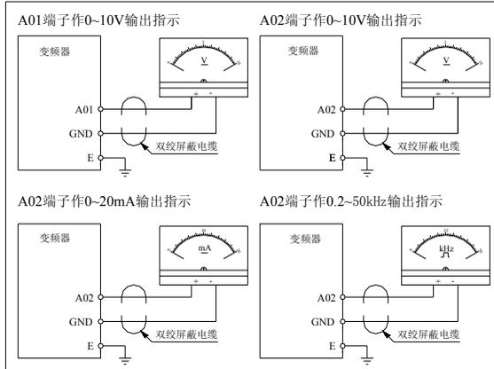
图 3-24：AC80B 系列变频器模拟量输出信号的连接方式
