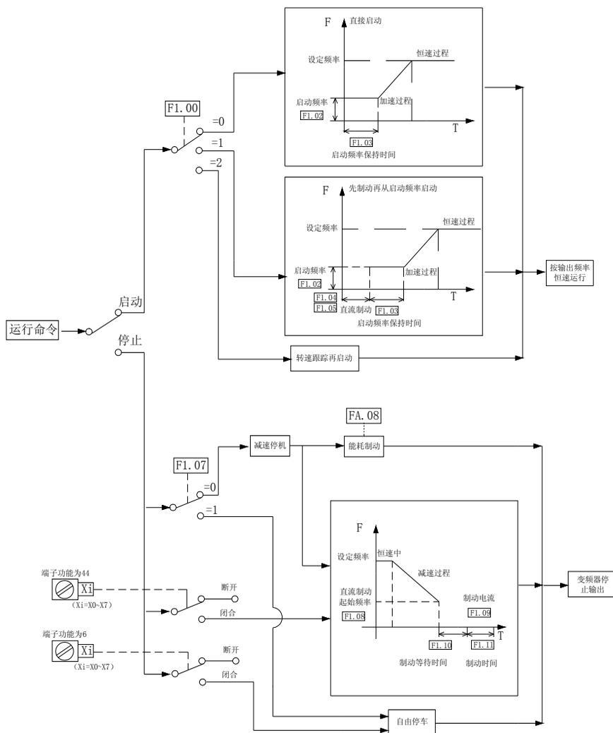
图 4-26：起停控制流程
