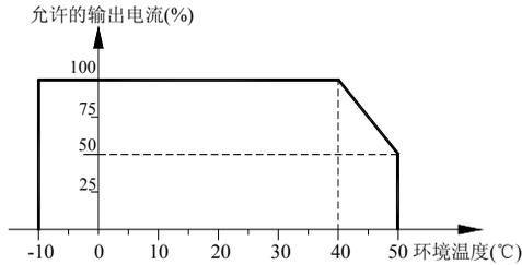
图 3-2: AC80B 系列变频器超出允许的使用温度后降额曲线图
