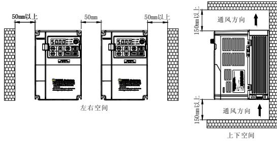
图 3-10：AC80B 系列变频器并列安装多安装空间要求
