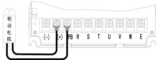
图 3-19: AC80B 系列变频器 18.5KW 以下机器制动电阻的连接图
