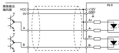
5.2.3 推挽输出编码器接线示意图
