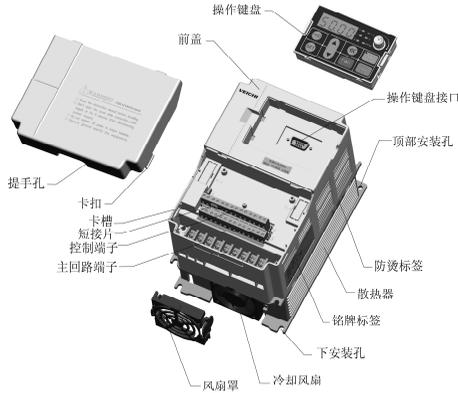
图 3-7: AC80B 系列变频器构成部分
