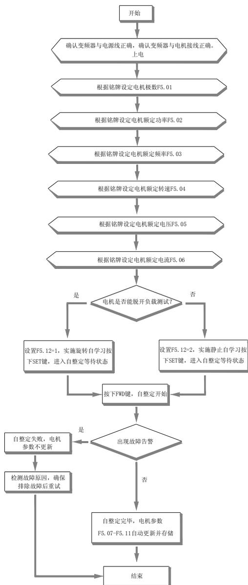
图 4-24：电机参数自整定
