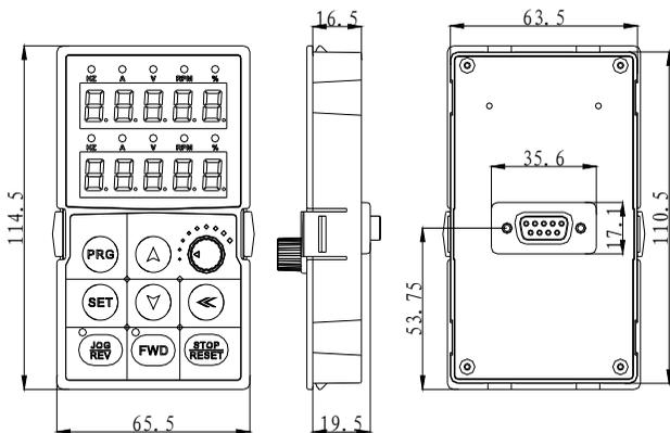
图 3-13: AC80B 系列变频器双行键盘外形尺寸
