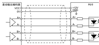
5.2.1 差分输出编码器接线示意图
