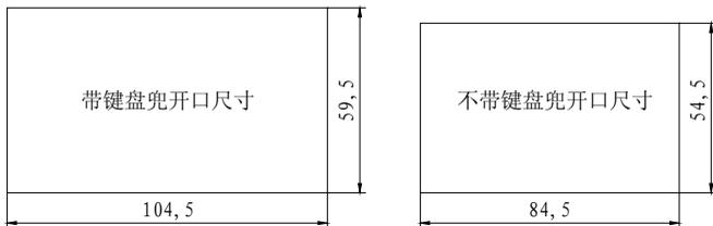
图 3-12: AC80B 系列变频器单行键盘机箱开口尺寸
