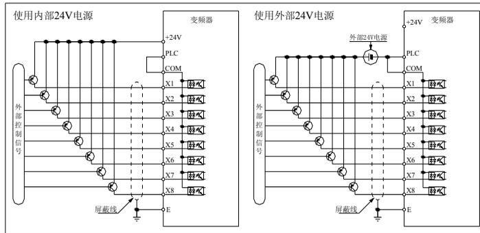
图 3-22: PNP 特性晶体的数字输入信号连接方式
