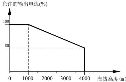
图 3-3: AC80B 系列变频器超出允许的海拔高度后降额曲线图
