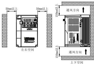
图 3-9: AC80B 系列变频器单机安装空间
