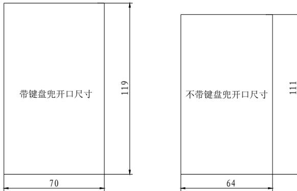
图 3-14：AC80B 系列变频器双行键盘机箱开口尺寸
