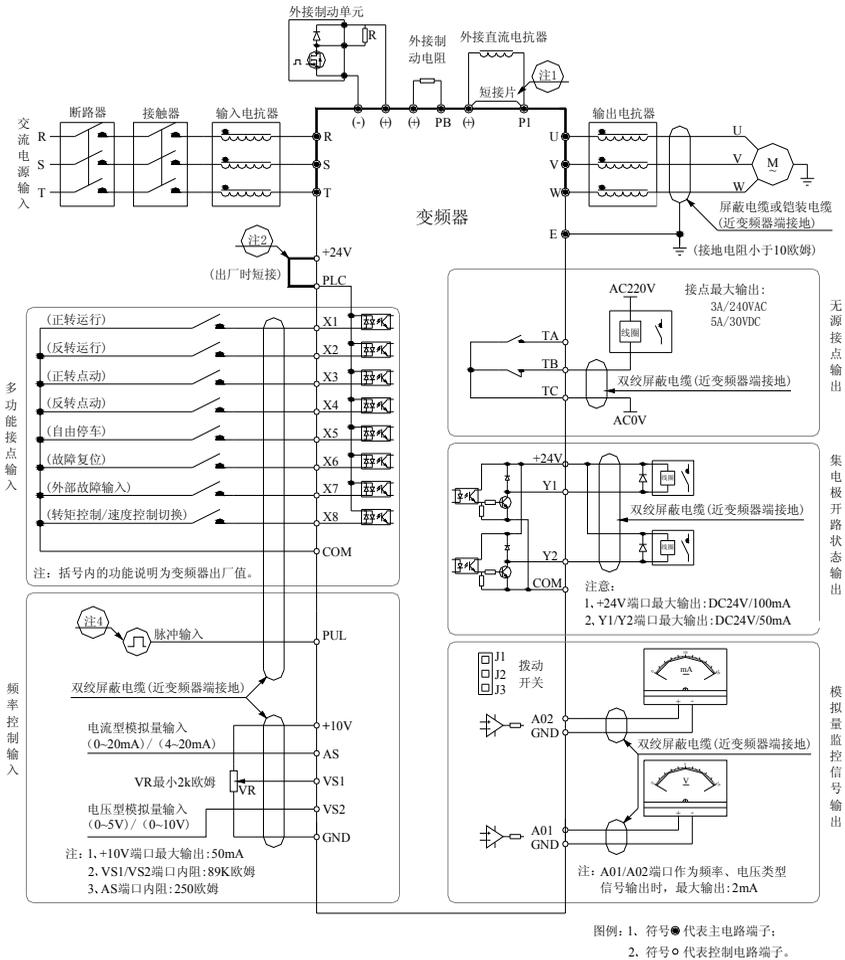
图 3-18: AC80B 系列变频器标准连接图
