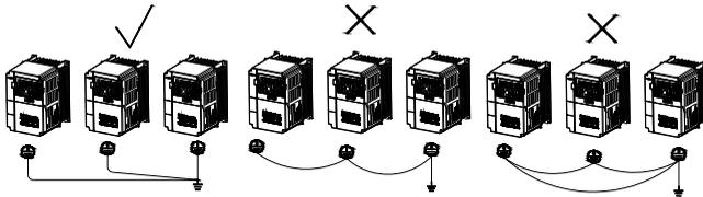
图 3-4：AC80B 系列变频器多台联合接地
