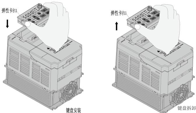
图 3-17：AC80B 系列变频器键盘的拆除与安装
