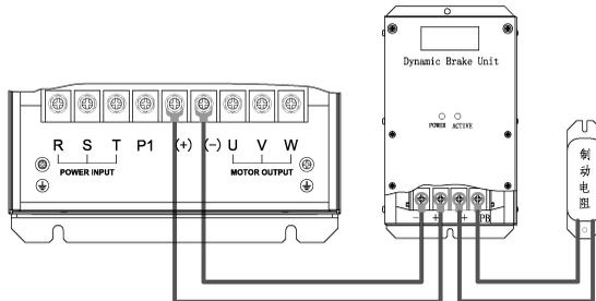
图 3-20: AC80B 系列变频器 22KW 以上机器制动电阻的连接图
