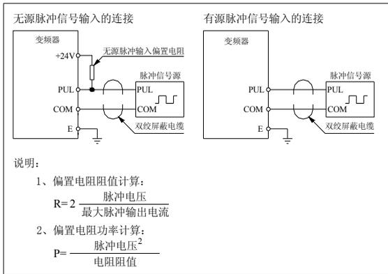
图 3-25：AC80B 系列变频器脉冲输入信号的连接方式
