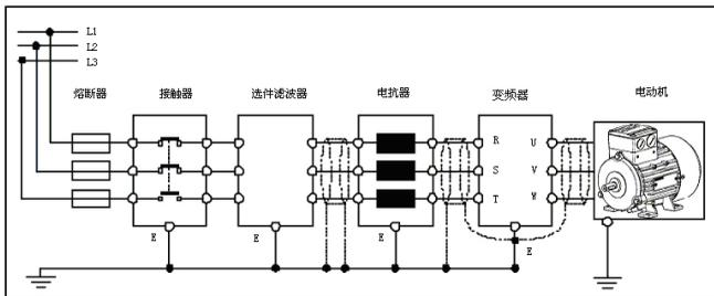
图 3-5：AC80B 系列变频器系统接地
