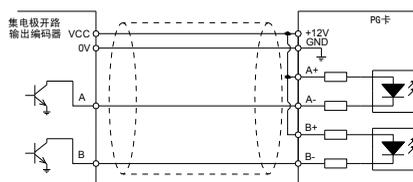
5.2.2 集电极开路输出编码器接线示意图
