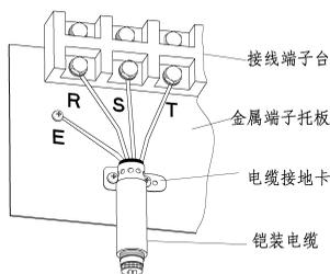
图 3-6：用电缆接地卡将各种电缆接地
