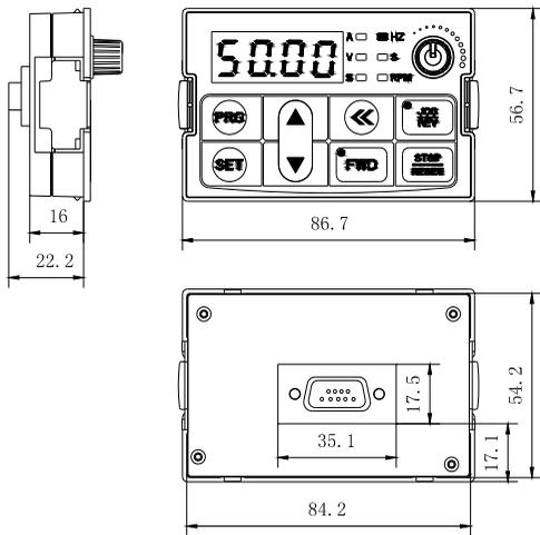
图 3-11: AC80B 系列变频器单行键盘外形尺寸
