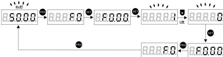
图 4-3：电机 1 控制方式选择
