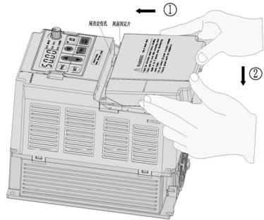
用手托住尾盖及变频器前盖的侧部，两大拇指放在提手孔位，稍用力向上顶起尾盖，直至尾盖底部两侧的卡扣都脱离卡槽位。然后再双手向后将固定片从固定孔中取出，尾盖拆卸完成。
