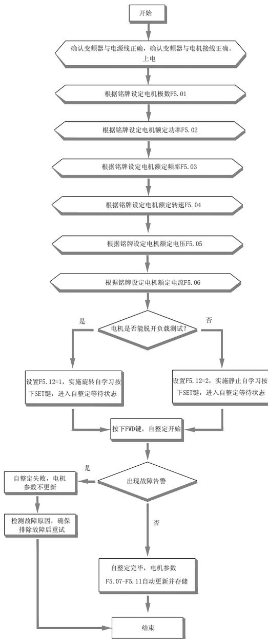
图 4-21：电机参数自整定
