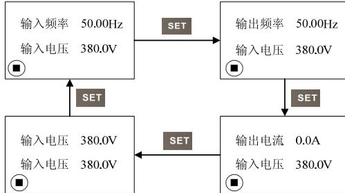
图 4-9：停机时上行监控参数显示更改
