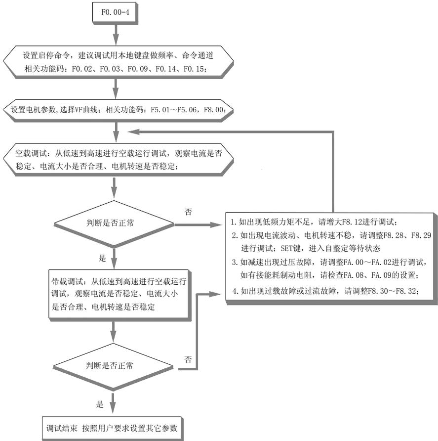
图 4-22: 异步电机 VF 调试步骤
