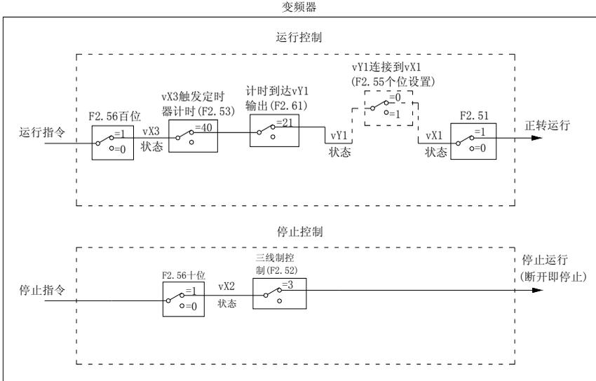
注：从上图可以看出采用常规方法需要接入两个实际外部 X 端子若采用虚拟端子则不需要接入外部实际端子。
