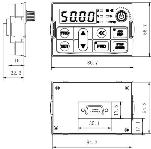
图 3-11: AC100 系列变频器单行键盘外形尺寸
