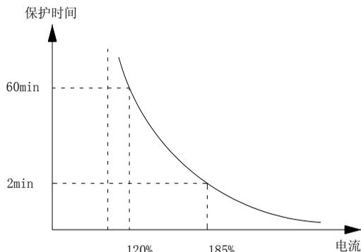
进入保护曲线的电流 = (电机实际电流 / 电机过载保护系数) \* 100%
