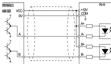
推挽输出编码器接线示意图
