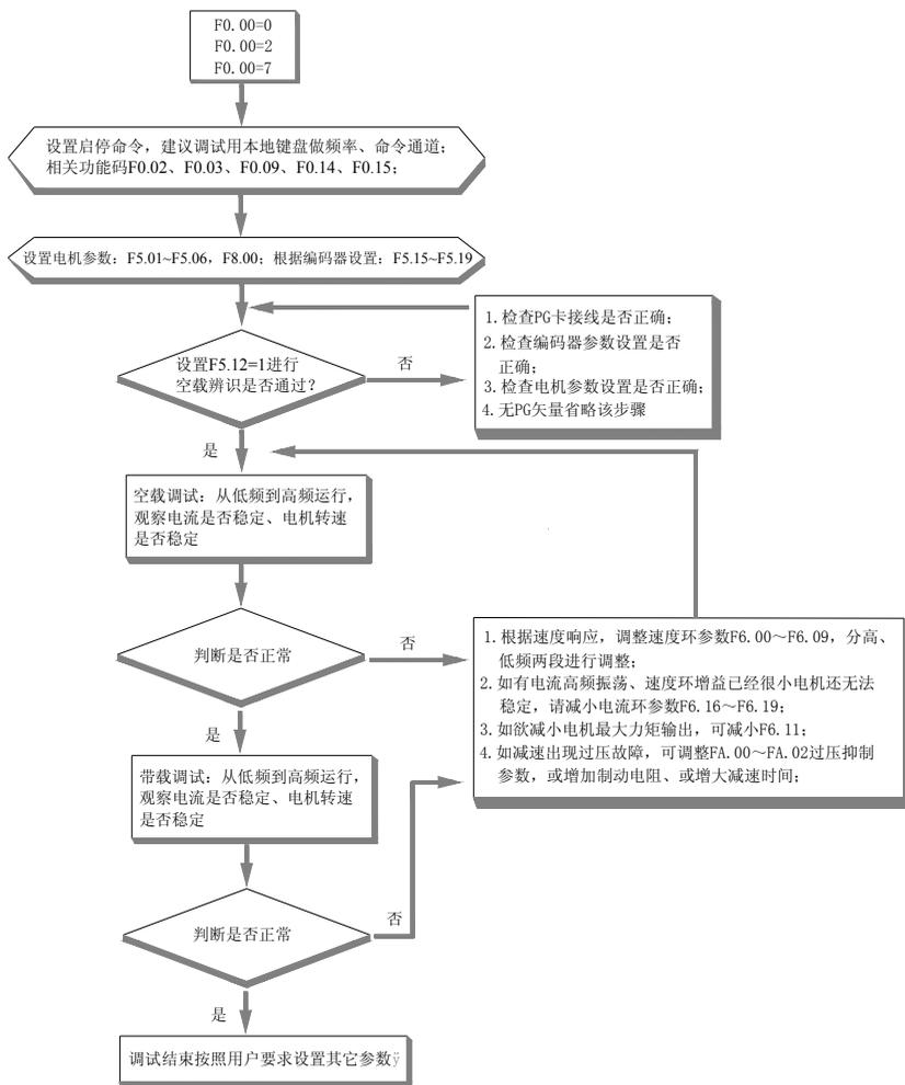
图 4-23：电机矢量控制调试步骤
