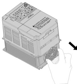
1、捏紧风扇的两边弹性卡扣，同时稍用力向外平行拉出，从变频器主体上拆下风扇罩。
