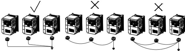
图 3-4：AC100 系列变频器多台联合接地
