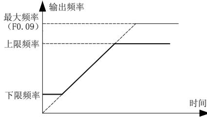
上、下限频率和最大频率关系示意图
