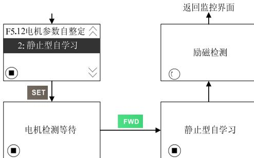
图 4-17：电机静止型自学习操作显示
