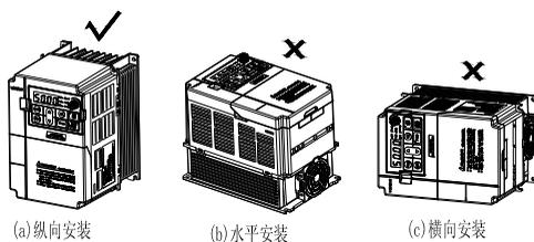
图 3-8：AC100 系列变频器安装方向
