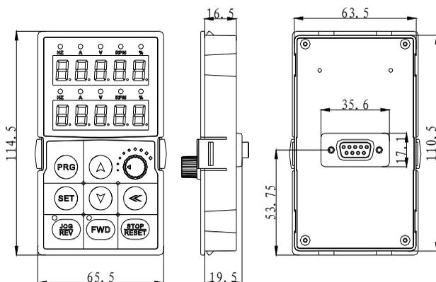
图 3-13: AC100 系列变频器双行键盘外形尺寸
