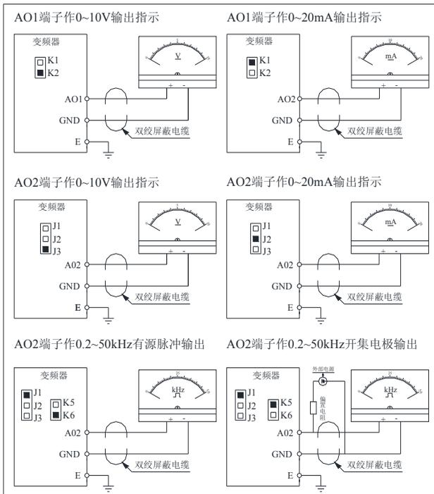
图 3-27：AC100 系列变频器模拟量输出信号的连接方式
