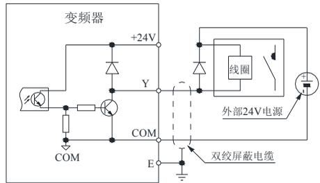
使用变频器外部24V电源实现对外部继电器的控制
