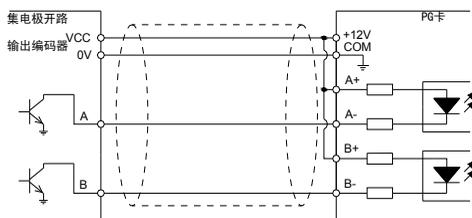
集电极开路输出编码器接线示意图
