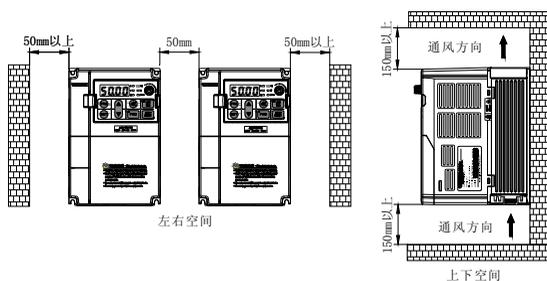
图 3-10：AC100 系列变频器并列安装多台安装空间要求
