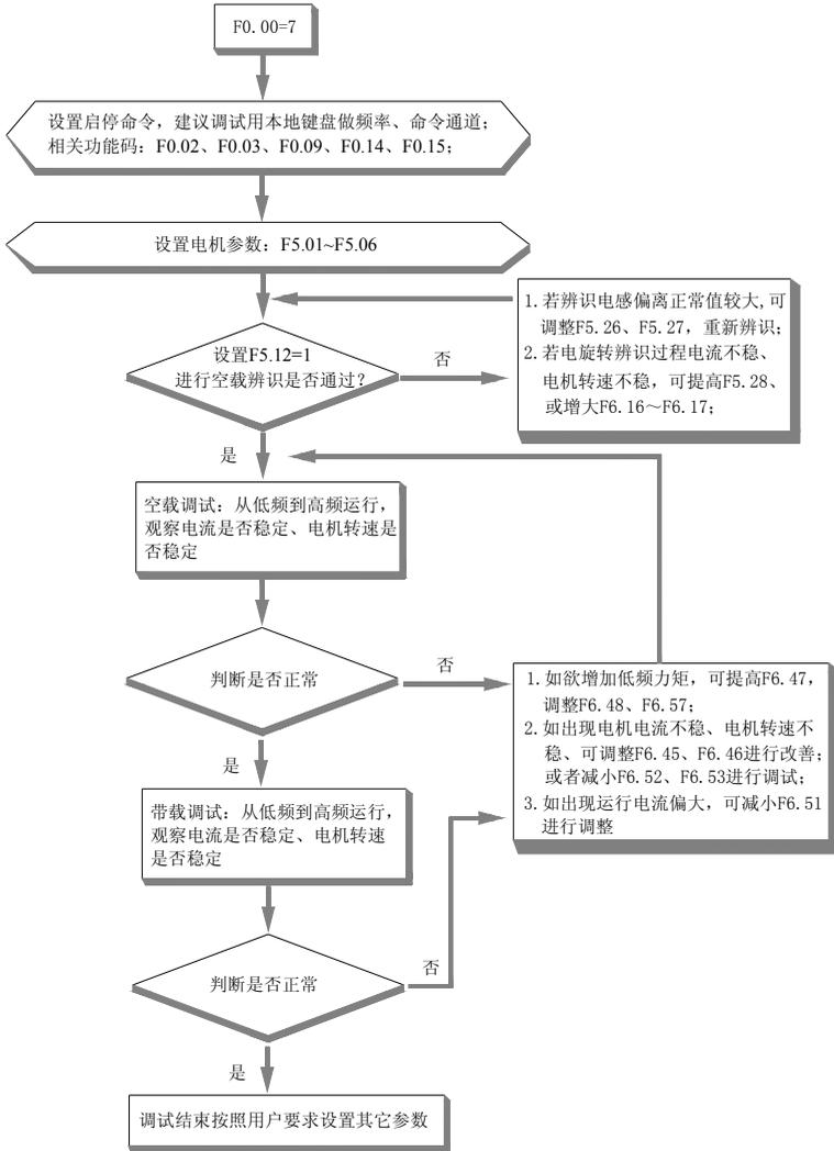
图 4-25: 同步电机无 PG 矢量控制调试步骤
