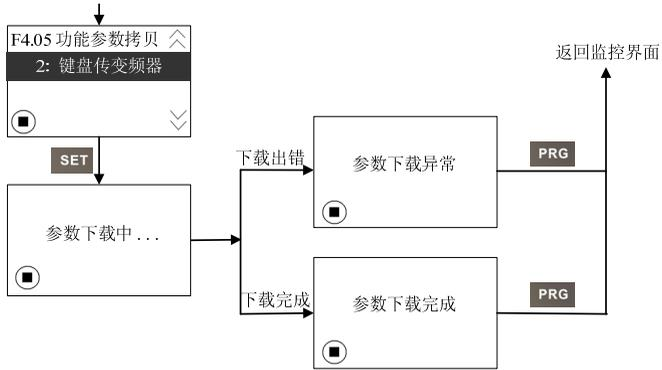
图 4-15：参数下载操作显示
