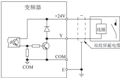
使用变频器内部24V电源实现对外部继电器的控制
