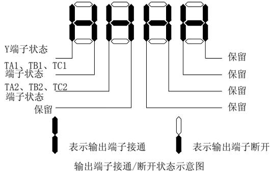
**提示：**C-31 监控扩展输出继电器 TA3-TC3、TA4-TC4 接通示意图与此相同，但只显示前面两位有效。
