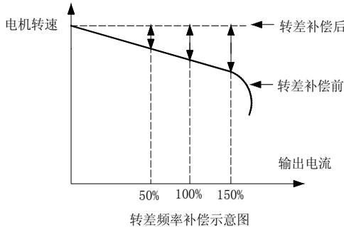
如果同自动转矩提升功能一起配合使用，可使变频器的低频力矩特性得到明显改善。转差频率补偿量的 100.0%对应电机额定转差，将补偿值设定得过大可能导致电机转速超过设定值。
