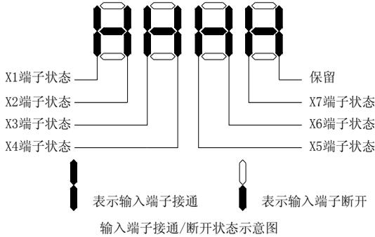
**提示：**C-30 监控扩展输入端子 X8~X10 接通示意图与此相同，但只显示前面三位有效。
