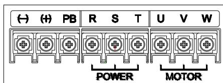
22~30kW 功率主电路端子排列顺序 (标准机无 PB 端子) (22kW 为铁壳机)
