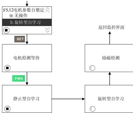
图 4-16：电机旋转型自学习操作显示
